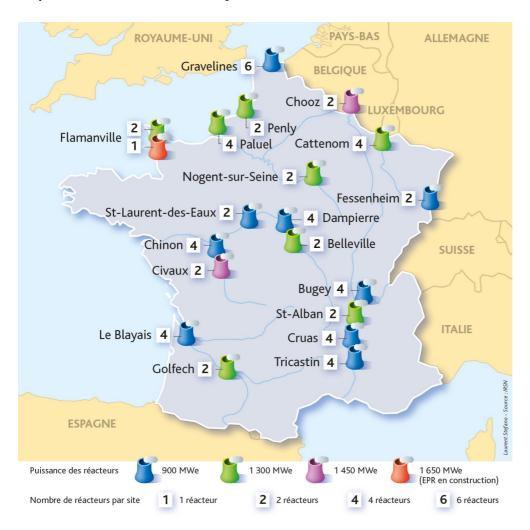
En France, en 2013, on compte 19 sites et 58 réacteurs électronucléaires en exploitation. Chaque site comporte deux à six réacteurs à eau sous-pression de génération II. Le réacteur en cours de construction à Flamanville dans la Manche (EPR) est de génération III.
