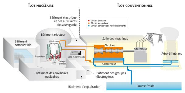
Le parc des réacteurs électronucléaires actuellement en service en France comprend un total de 58 réacteurs à eau sous pression (REP). Les principaux constituants des réacteurs à eau sous pression en France de manière générique et schématique- sont l'ilot nucléaire (ou la fission nucléaire produit de la chaleur) et l'ilot conventionnel (où cette chaleur est transformée en courant électrique et fournie au réseau de transport).
